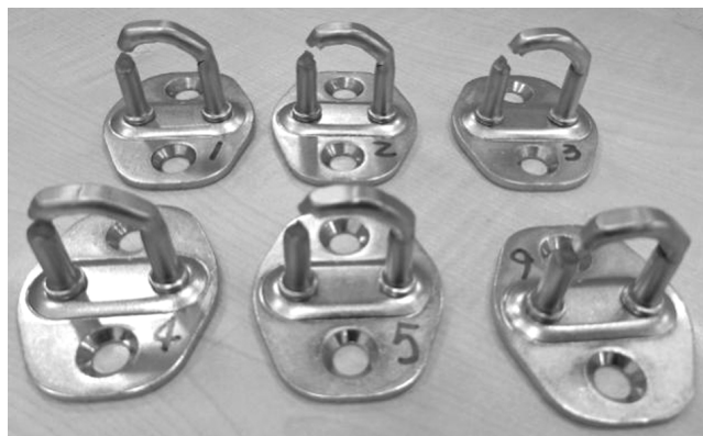
图7 车门锁扣纵向强度试验后样品
