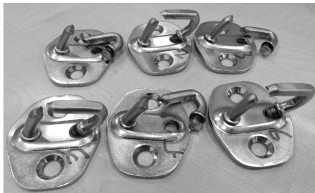
图8 车门锁扣横向强度试验后样品
