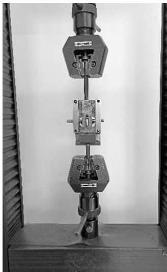
图6 车门锁扣强度试验
